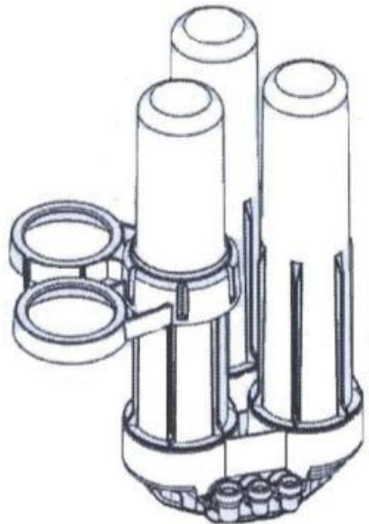
**Заметка:** Если меняется только префильтр, нет необходимости в отвинчивании колб с мембранными элементами. Если меняются мембранны, следует также заменить и префильтр с постфильтром.
