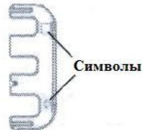
После того, как выполнены все соединения, необходимо установить планку – фиксатор блока фитингов. У неё есть нижняя и верхняя части. В перевернутом положении она не встанет на место. Для правильной её ориентации на корпусе предусмотрены два символа. Планка может вставляться как слева, так и справа.
